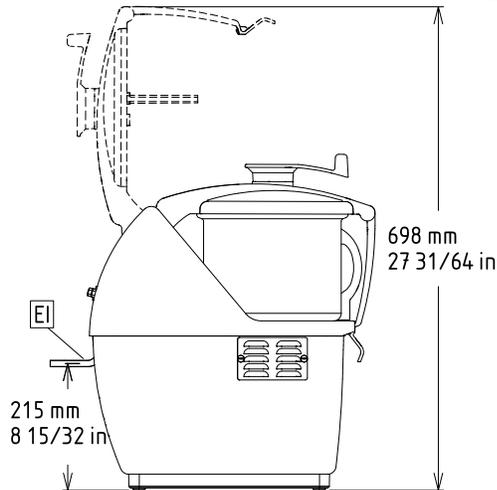
**EI** = Conexión eléctrica (energía)
